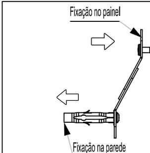
Obs: Para furação na parede, utilizar informações dos detalhes 3 ao 6. Fixar a "chapa metálica (A)" conforme "detalhe 2" na parede com a "bucha (E)" e parafuso (D)".
