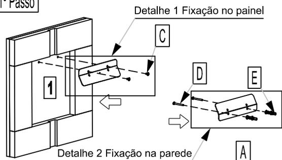
Utilizar uma chave philips para fixar a "chapa metálica (A) no fundo (1)" com o "parafuso (C)" como mostra o "Detalhe 1".
